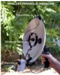
Peter Sinclair perfectionne un dispositif qui lie une captation sonore sélective à une web cam, le tout sans fil. Cet outil, inspiré de la parabole utilisée pour le stream « PAM » ainsi que la parabole rotative de l'installation de Cap 15, permet de créer un stream mobile. Il capte des sons qui sont transmis et éventuellement retraités directement via un ordinateur. L'image réelle de l'objet sonore est transmise simultanément par la web cam et présente la même focalisation que le micro.
