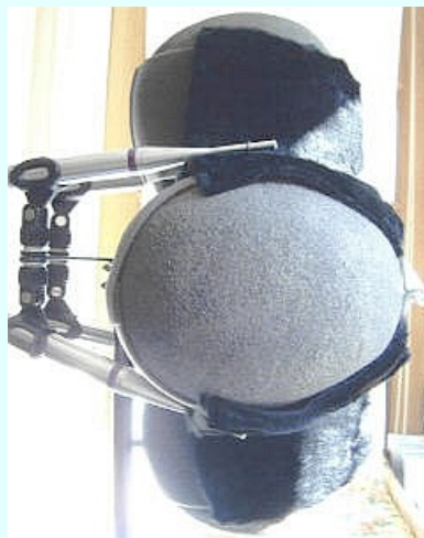
Système de prise de son à quatre micros de Jacques Chaponnay. Il tient compte non seulement du plan horizontal mais aussi de la hauteur. Pour une bonne reproduction, il faut quatre enceintes placées dans les angles de la pièce d'écoute, deux en haut et deux en bas. Les micros utilisés sont des Earthworks omnidirectionnels QTC-1, séparés par des boules en feutrine. (Photo Jacques Chaponnay)
